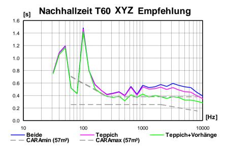
Eine Reduktion der Nachhallzeit < 200 Hz ist nur durch speziell angepasste Platten- oder Helmholtzabsorber möglich.
